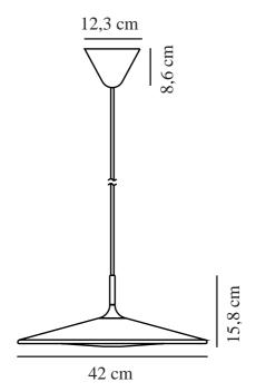
Tension (V): 230 Volt Protection IP: IP20 Classe (Classe 1, Classe 2, Classe 3): Classe 2 (Double isolation) Culot d'ampoule: LED Module : True
