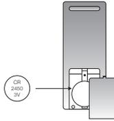
**FR:** Retirez le couvercle de la pile et insérez 1 pile CR 2450 3V.
