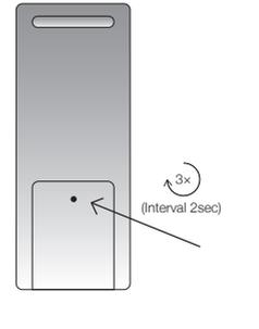
**FR:** Cliquez 3 fois, avec un intervalle de 2 secondes, sur le bouton de configuration situé à l'arrière de la télécommande à l'aide d'un objet pointu. Ensuite, le « 1 » situé dans le coin supérieur commencera à clignoter d'une lumière bleue.
