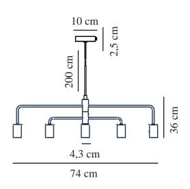
Tension (V): 230 Volt Protection IP: IP20 Puissance maximale de l'ampoule (W): 5x40 Classe (Classe 1, Classe 2, Classe 3): Classe 2 (Double
