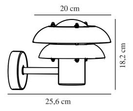
Spannung (V): 230 Volt IP-Grad: IP54 Maximale Lampenleistung (W): 12W Klasse (Klasse 1, Klasse 2, Klasse 3): Klasse 1 (Geerdet) Leuchtmittelsockel: E14
