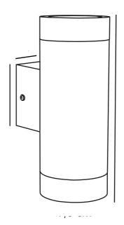
Spannung (V): 230 Volt IP-Grad: IP54 Maximale Lampenleistung (W): 35 Klasse (Klasse 1, Klasse 2, Klasse 3): Klasse 1 (Geerdet) Leuchtmittelsockel: GU10 Parallelschaltung: False
