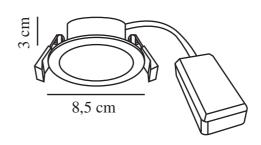
Spannung (V): 220-240 Volt IP-Grad: IP65 Klasse (Klasse 1, Klasse 2, Klasse 3): Klasse 2 (Dopp. isoliert) Leuchtmittelsockel: LED Module Parallelschaltung: True
