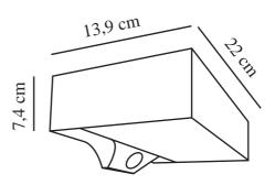
Tension (V): 5 Volt Protection IP: IP44 Classe (Classe 1, Classe 2, Classe 3): Classe 3 (12V) Culot d'ampoule: SolarLed Installation du commutateur: À l'intérieur du luminaire Connexion parallèle: False
