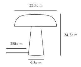
Spannung (V): 220-240 Volt IP-Grad: IP20
