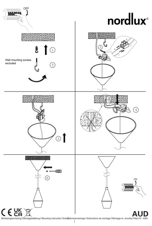
DNK - Klasse II: Lampen er dobbeltisoleret og kræver derfor ikke tilslutning til installationens jordledning.
