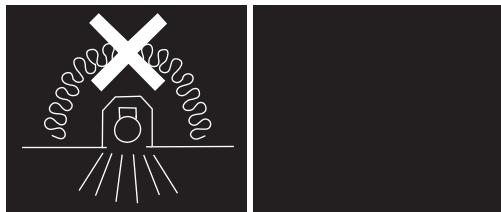
**DNK** - Lampen må ikke tildekkes med isolermateriale.
