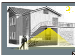
Om ljuset i rummet är otillräckligt tänds sensorn lampan när rörelse detekteras.
