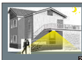
Er der ikke nok omgivende lys, tænder sensoren først lampen, når bevægelse registreres.
