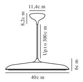
Spannung (V): 230 Volt IP-Grad: IP20 Klasse (Klasse 1, Klasse 2, Klasse 3): Klasse 2 (Dopp. isoliert) Leuchtmittelsockel: LED Module : True
